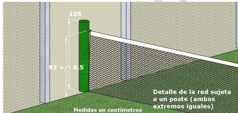
El dispositivo de tensión del cable debe de estar concebido de tal modo que no se suelte de forma inesperada y no constituya un riesgo para los jugadores.
