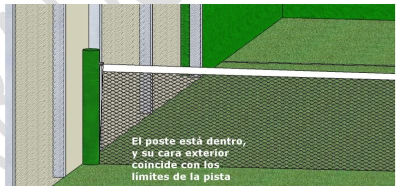
Los postes de la red tienen sus caras exteriores coincidiendo con los límites laterales de la pista (abertura, puerta o malla metálica). Pueden ser de sección circular o cuadrada pero tendrán sus aristas redondeadas.
